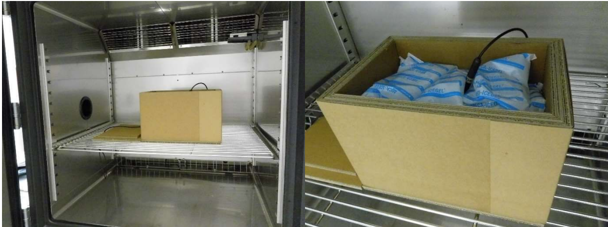
Abbildung 1: Vorkonditionierung – Prüfaufbau für den Dummy Inhalt
