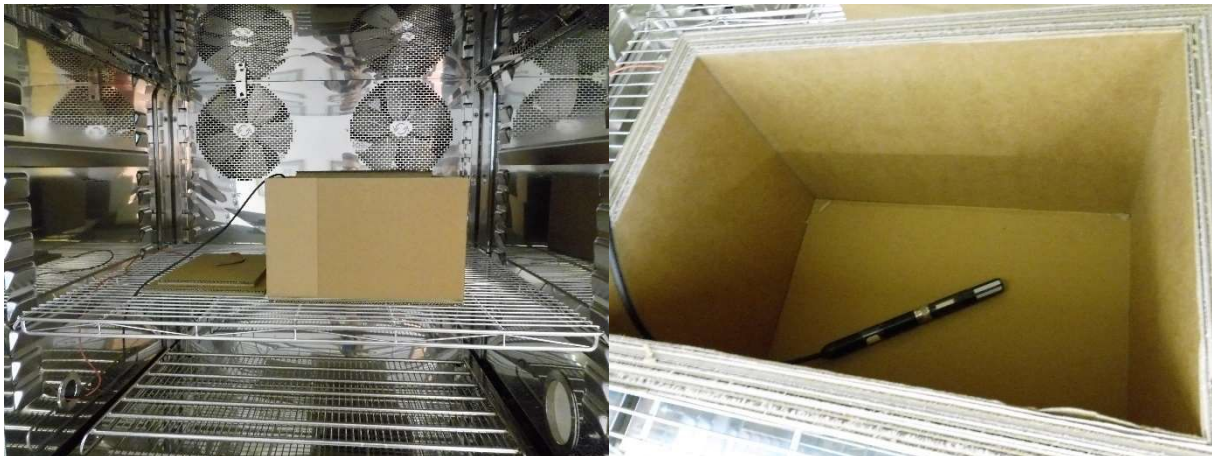
Abbildung 2: Vorkonditionierung – Prüfaufbau für die Versandkartons
